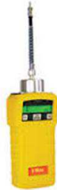
Fotoionizzatore portatile per analisi COV (Componente Organica Volatile) nei suoli campionati
