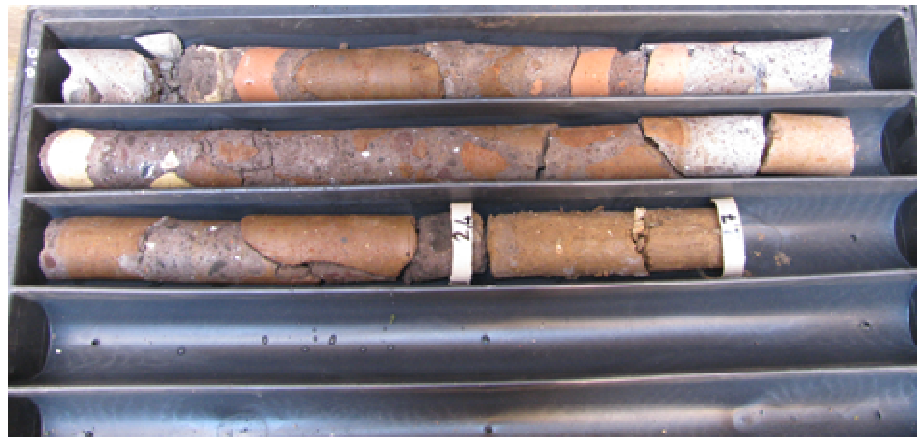
Carotaggi su muratura con carotiere T6S (recupero del 100%)
